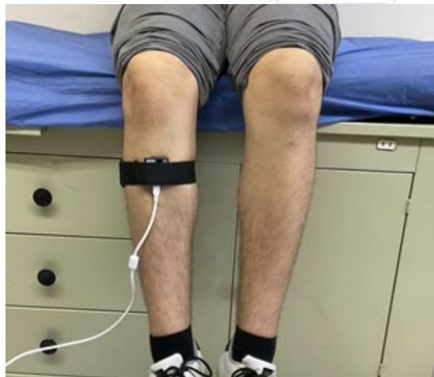
Figura 2: Sensor inercial PhidgetSpatial Precision ® para medir grados de rotación interna y externa
